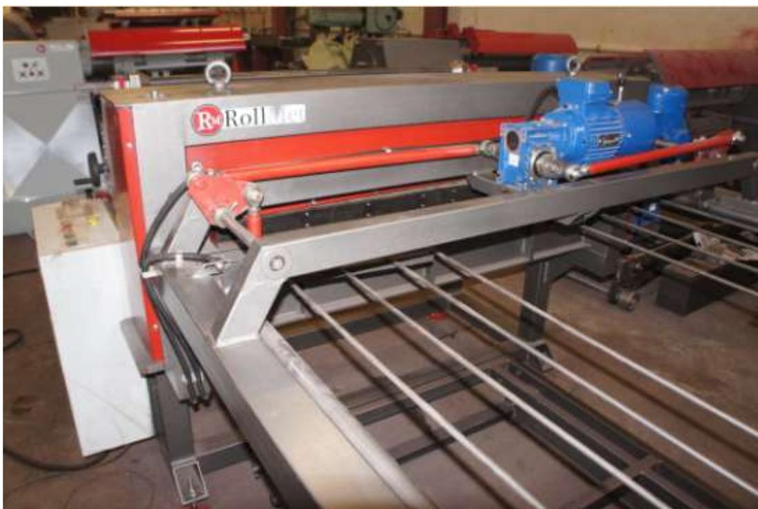
**Спецификация линии поперечной резки рулонного металла толщиной от 0,4 мм до 2,5 мм**
